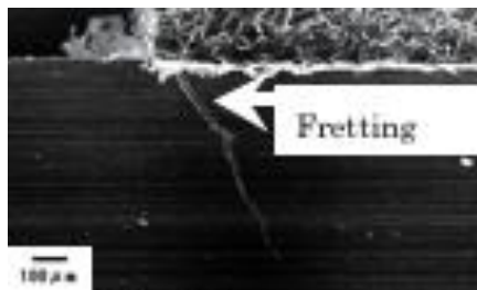
フレットング疲労き裂進展 のその場観察例
