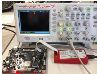
図 1. AES 回路の FPGA 実装
