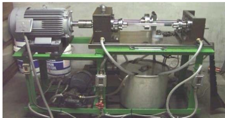
図1 FZG動力循環式歯車運転試験機
