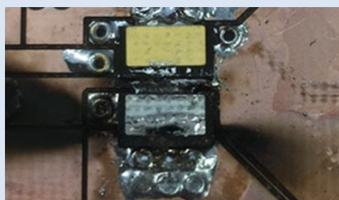
Fig. 2 GaN 誤点弧による熱暴走
