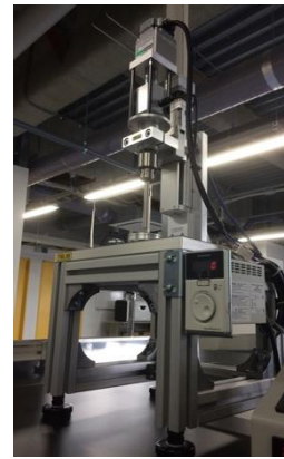
ソフトマテリアルリング用の摩擦測定装置開発
