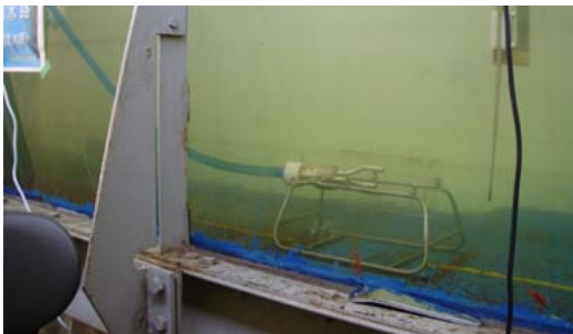
ADCP による汽水域の流動観測
