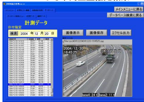
BWIM による車両重量推定結果
