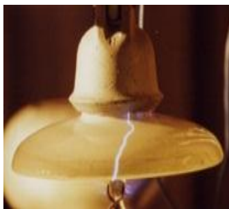
図1 がいし表面の沿面放電
